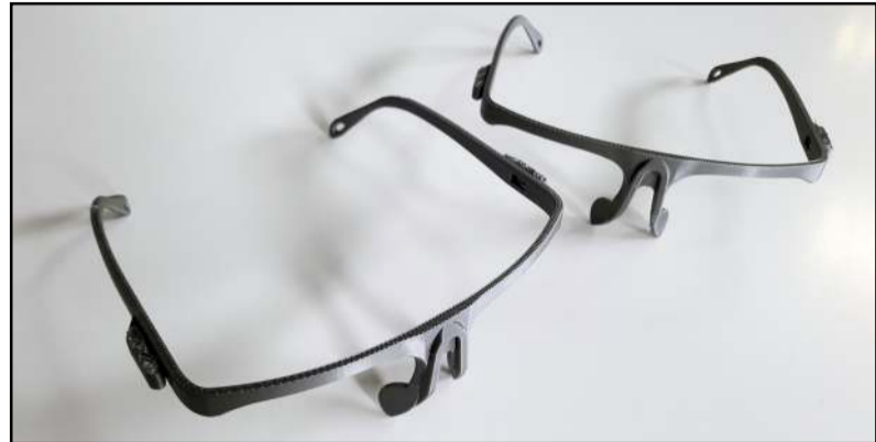
Pirmieji apsaugos skydų rėmeliai, atspausdinti A. Balandos „Zortrax“ 3D spausdintuvu
